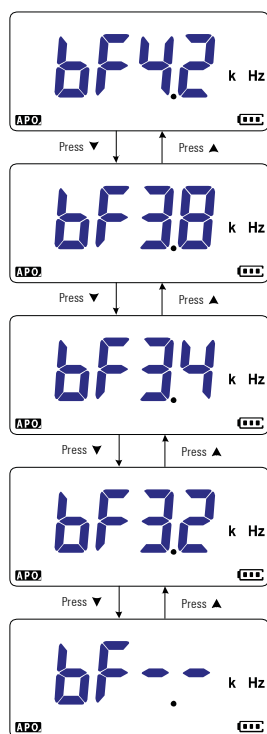
Figure 4-4 Modification de la fréquence du signal sonore
