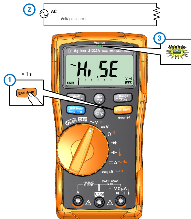
Figure 3-1 Détection de la présence d'une tension
