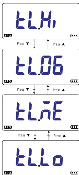
Figure 4-9 Réglage de l'intensité de la lampe à DEL
