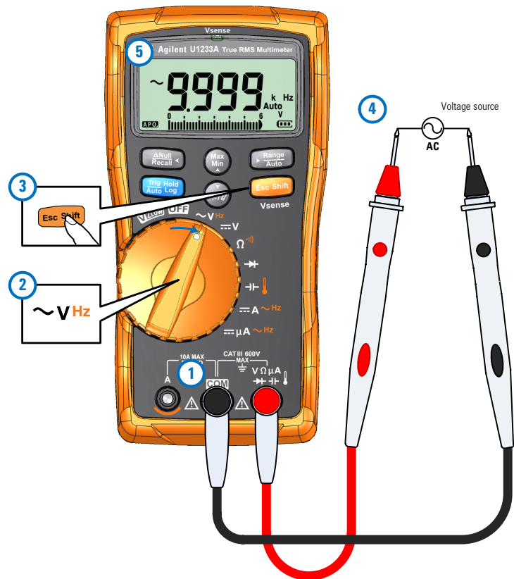
Figure 2-28 Mesure de la fréquence
