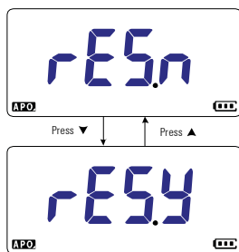
Figure 4-13 Réinitialisation des éléments de configuration
