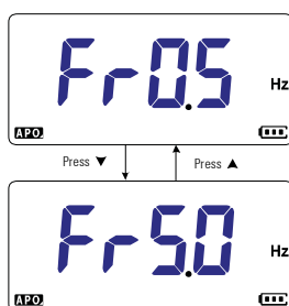
Figure 4-10 Modification de la fréquence minimale mesurable
