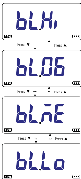
Figure 4-7 Réglage de l'intensité du rétroéclairage LCD
