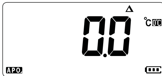
Figure 2-21 Mesure de température sans compensation ambiante
